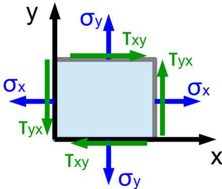
Spannungszustand für positive Spannungen
