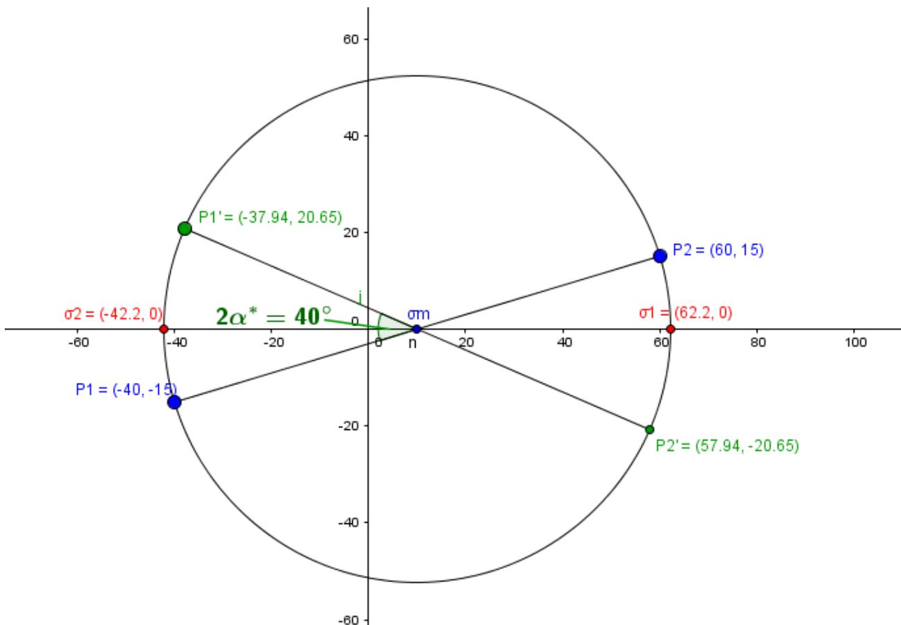
Die Spannungszustand für eine Drehung des Ausgangskordinatensystems um  $20^\circ$  gegen den Uhrzeigersinn (Linksrotation = positiver Winkel) ergibt:
