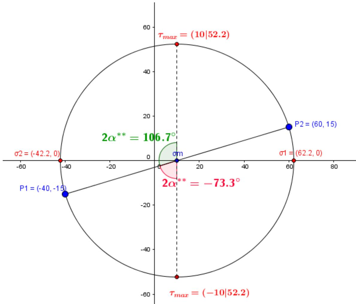
Es sind zwei Winkel abgetragen worden. Zum einen für die positive Hauptschubspannung bei  $(10|52,2)$  und für die negative Hauptschubspannung bei  $(-10|52,2)$ . Die Hauptrichtung  $\alpha^{**}$  bei welcher die positive Hauptschubspannung auftritt, ergibt sich, indem von der Verbindungslinie  $P_1$  und  $\sigma_m$  der Winkel zur oberen senkrechten Linie bei  $\sigma_m$  abgetragen wird:  $2\alpha^{**} = 106,7^\circ \rightarrow \alpha^{**} = 53,4^\circ$ .
