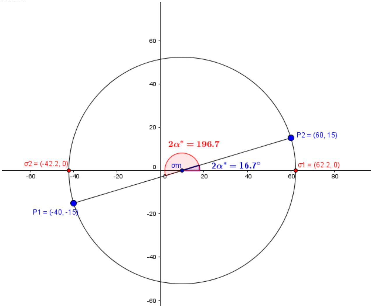
Es existieren dabei zwei Winkel. Einmal von der Teilverbindungsline zwischen  $P_1$  und  $\sigma_m$  zur positiven x-Achse, und einmal von der Teilverbindungsline zwischen  $P_2$  und  $\sigma_m$  zur positiven x-Achse:
