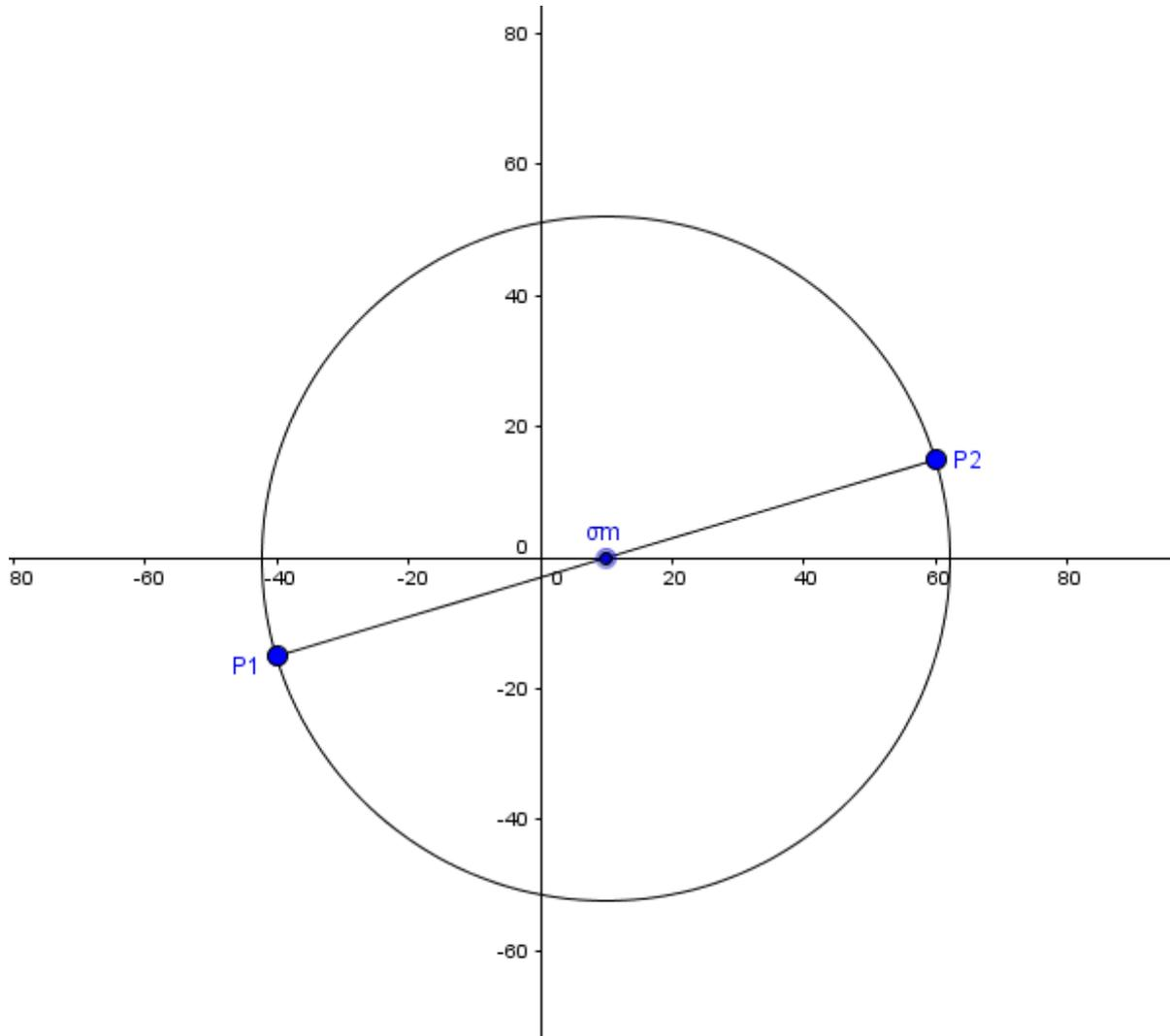
$\sigma_m$  liegt dann auf dem Schnittpunkt zwischen der  $\sigma$ -Achse und der Verbindungslinie.
