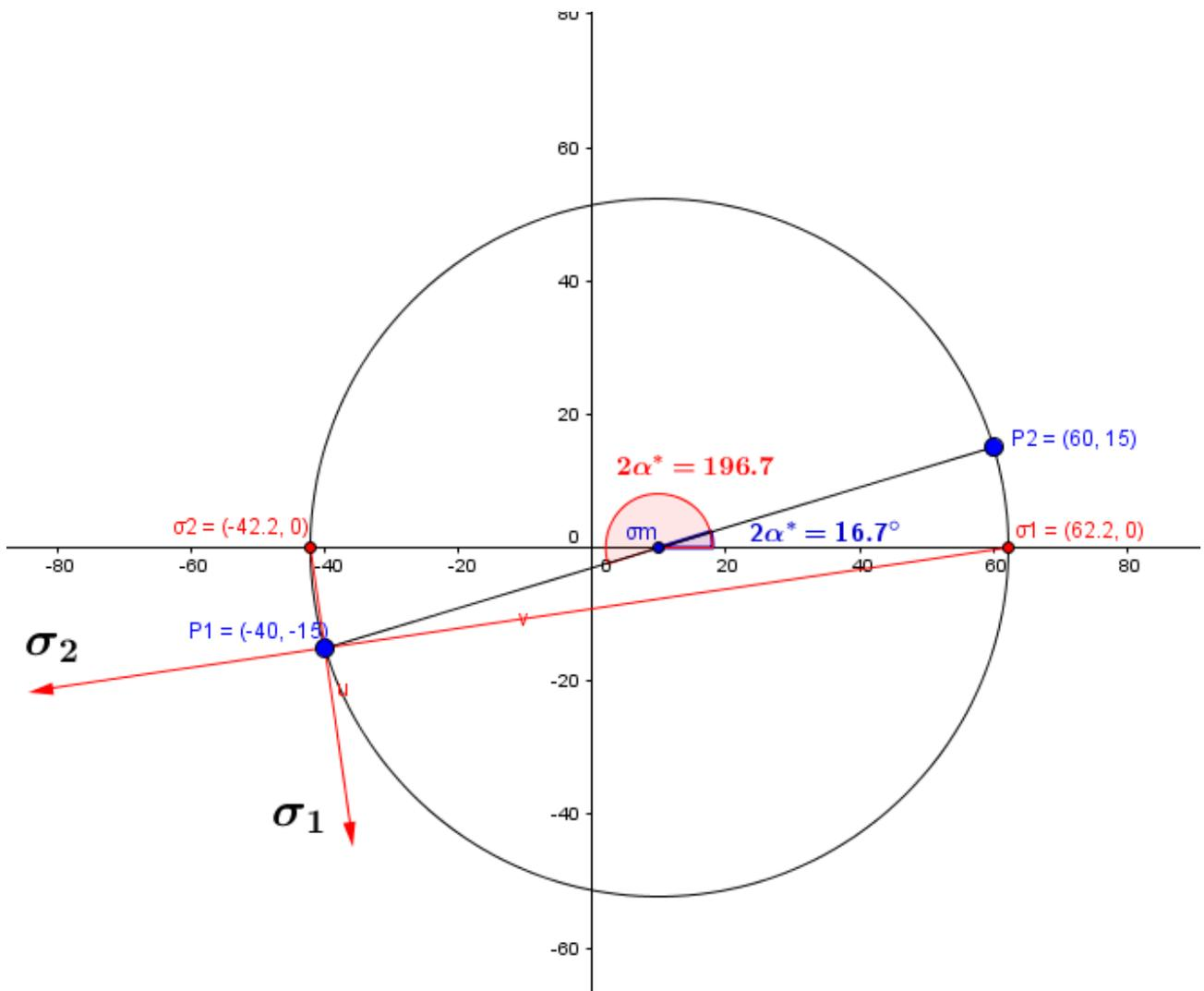
Die Winkelabtragung erfolgt immer von den Haupttrichtungen zur **positiven**  $\sigma$ -Achse. Dabei müssen diese gegebenenfalls verlängert werden:
