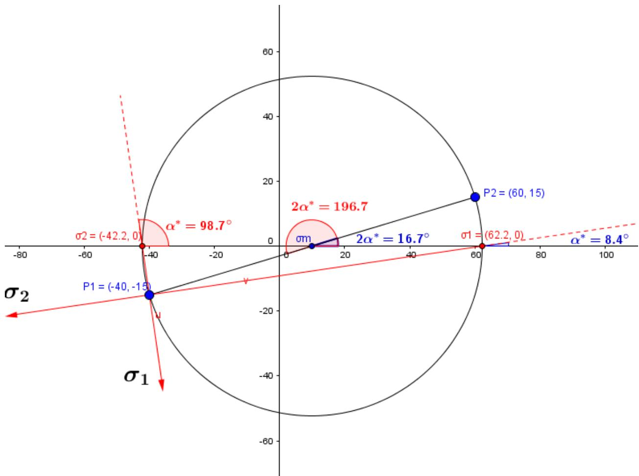
Es ist deutlich zu erkennen, dass der Winkel von  $8,4^\circ$  für die Hauptnormalspannung 2 und der Winkel von  $98,7^\circ$  für die Hauptnormalspannung 1 gilt. Bei dieser Abtragung wird nur der einfache Winkel berücksichtigt.
